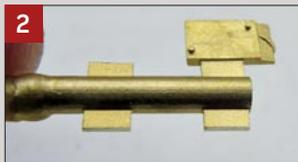
2 „Fussel“ an einer Gleitbahn einer Rpg. Das hervorstehende Material muß abgetragen werden, sonst passt hinterher die Schiene nicht in diesen Bereich hinein ...
