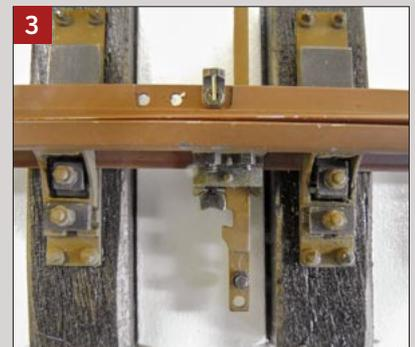
1 Der Klammerspitzenverschluss mit dem Verschlussstück,
