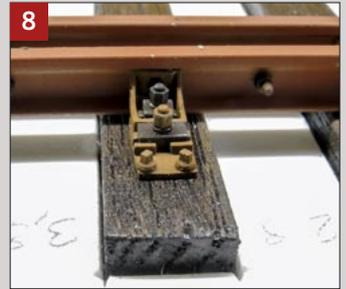
ßiges Anlagebild an die Backenschiene gibt, sollte man sich zufrieden geben. Insbesondere bei der kürzesten Knappe wird es erforderlich sein, auch den Kopf der Vierkantschraube mit anzufassen oder gar abzuarbeiten, damit der Zungenfuß nicht an diesen Kanten anläuft.
