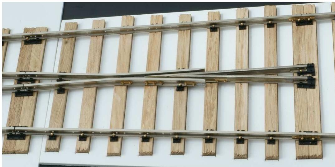
Von der Herzstückspitze in Richtung Weichenende werden nun an jeder Vollschiene zwei halbe Rp16 in die vorhandenen Bohrungen montiert.
