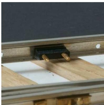
In Längsrichtung gesehen weisen die Futterstücke eine leichte Neigung auf; die Kanten sind nicht parallel. So wird die auf das engste Maß im Bereich der Herzstückspitze zulaufende Spurrille hergestellt. Daher sollten die Futterstücke nicht verwechselt werden.
