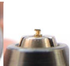
Die Angußreste müssen vollständig entfernt sein, sonst passt der Kopf der Schraube hinterher nicht zwischen Backenschiene und Zunge.
