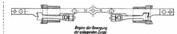
... und zieht den Klammerkopf in die Tasche der Stange. Damit sind nun Stange und Klammer starr miteinander verbunden. Zudem passen in diesem Zustand die Stange mit der Klammer durch die Öffnung des Verschlußstücks: die weitere Bewegung der Stange nimmt die Klammer mit. Ab jetzt wird dadurch die Zunge mitbewegt und legt von der Backenschiene ab.
