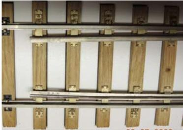
Also etwa so wie auf dem Bild. Die Zungenspitzen liegen ohne weitere Beeinflussung locker auf den Enden der ersten Rippenplatten auf.
