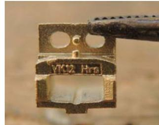
Das Verschlussstück hat auf der Unterseite ein kleines angegossenes Rechteck. Dies ist kein Gußkanal, sondern der tatsächliche Umriss des Originalteils. Eine kurze Paßprobe auf der
