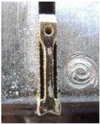
Die Verschlussklammern Vk18 werden auf Grate kontrolliert und die Gußkanalreste auf der Unterseite vollständig entfernt. Hier darf keine Unebenheit stehen bleiben, ansonsten gleitet die Vk18 nicht sauber in der Vk12.
